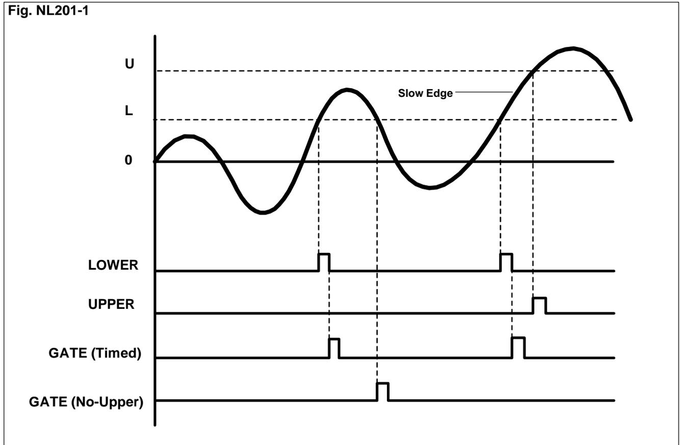
Fig. NL201-1 : Level detection
